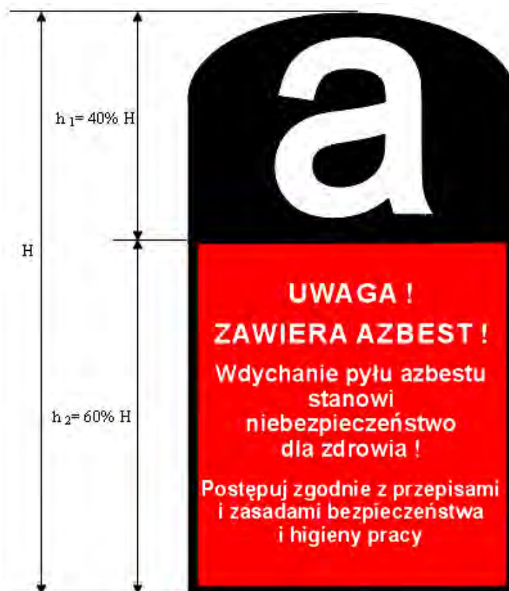
Rysunek 4. Wzór oznakowania instalacji lub urządzeń zawierających azbest oraz rur azbestowo-cementowych ( H = \text{min. } 5 \text{ cm} ).
